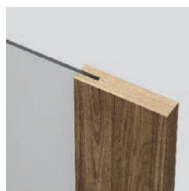
spojenie so sklom „na hranu“ bezpoldrážkové krídlo
